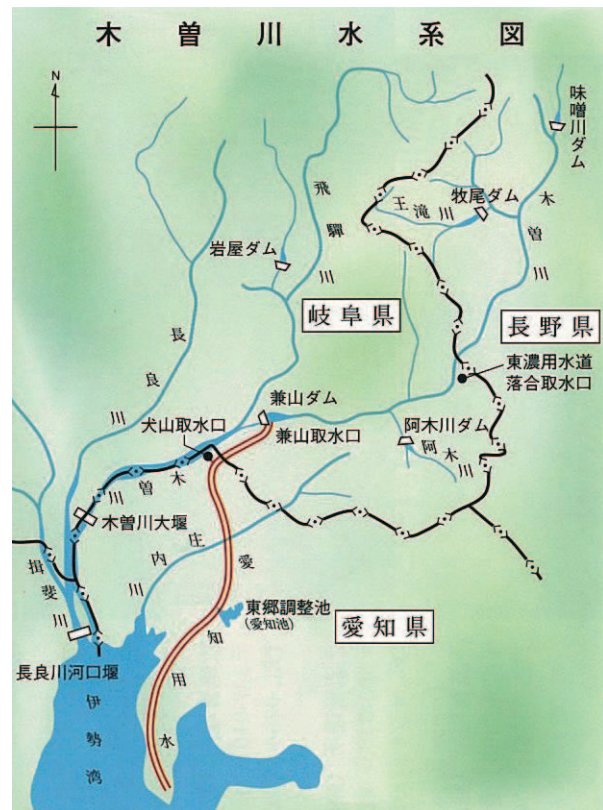
木曾川水系図 木曾川水系における愛知用水の水源施設（牧尾、味噌川、阿木川の各ダム）、兼山取水口および幹線水路などの配置概略図
