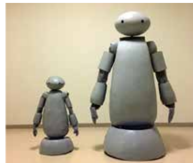
図1 KEPRO、感性表出実験用ロボット(高さ700mmと1300mm)
