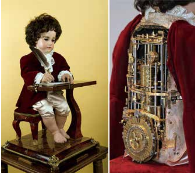
図2 18世紀フランスの職人P.J.ドロが制作した、文章を書く オートマトン 自動機械 (COLOSSALのウェブサイトより)
